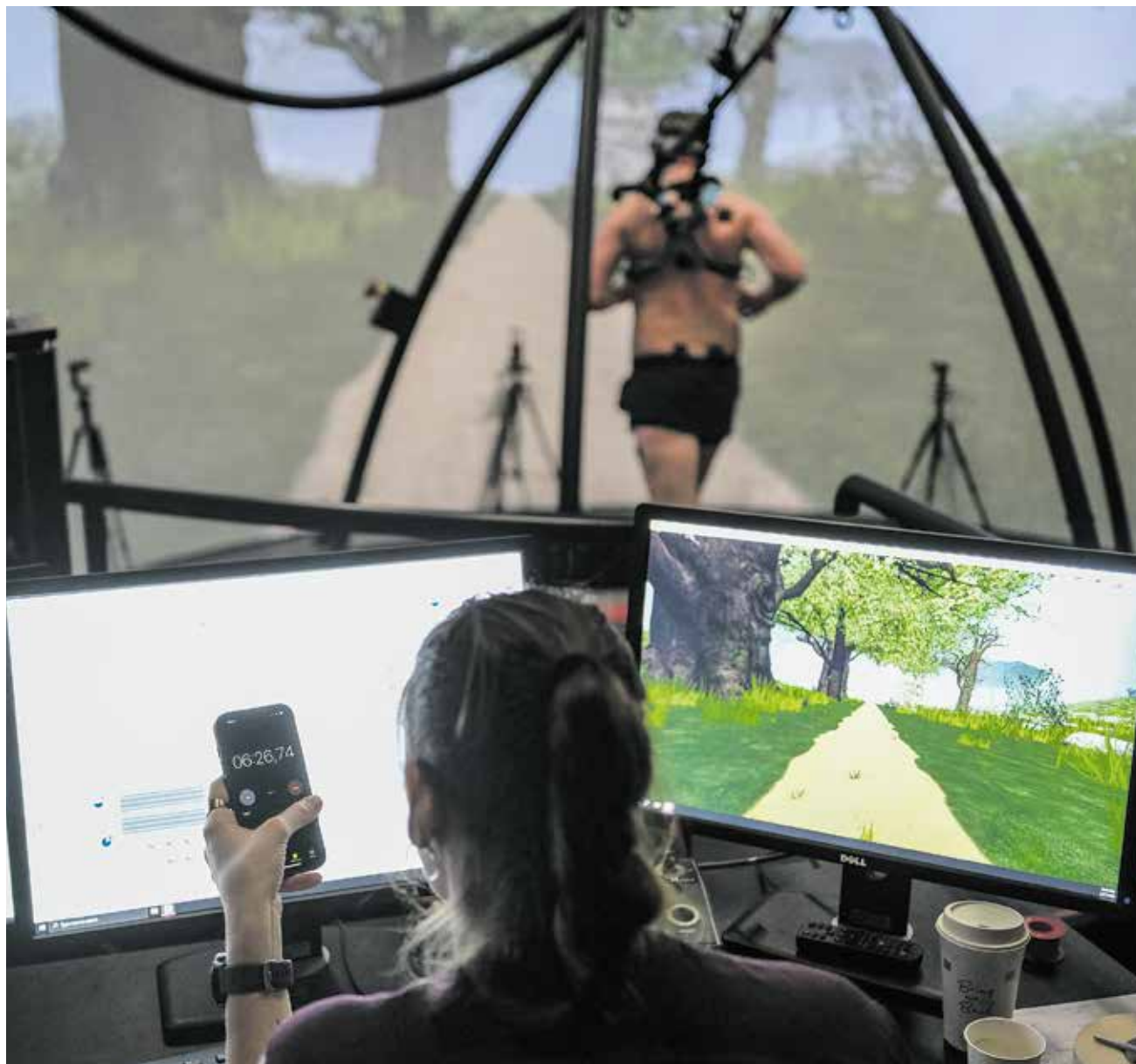
Een hardloper in het Maastrichtse lab. Camera's en sensoren registreren de belasting op zijn lichaam terwijl hij op een loopband rent Foto: Joey Roberts
